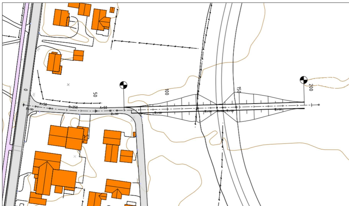
Figur 73. Plantegningen viser prinsipp for ny landbruksadkomst over flomvollen. Løsningen vil bli sett nærmere på i detaljprosjekteringen. Kilde: Rambøll, plan- og profiltegning 26.02.26
