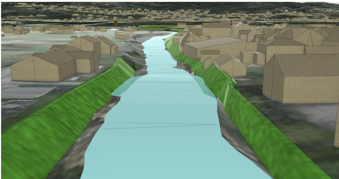
Figur 44 viser flom- og erosjonssikringstiltaket i Rukkedøla sett fra Hajem bru.
