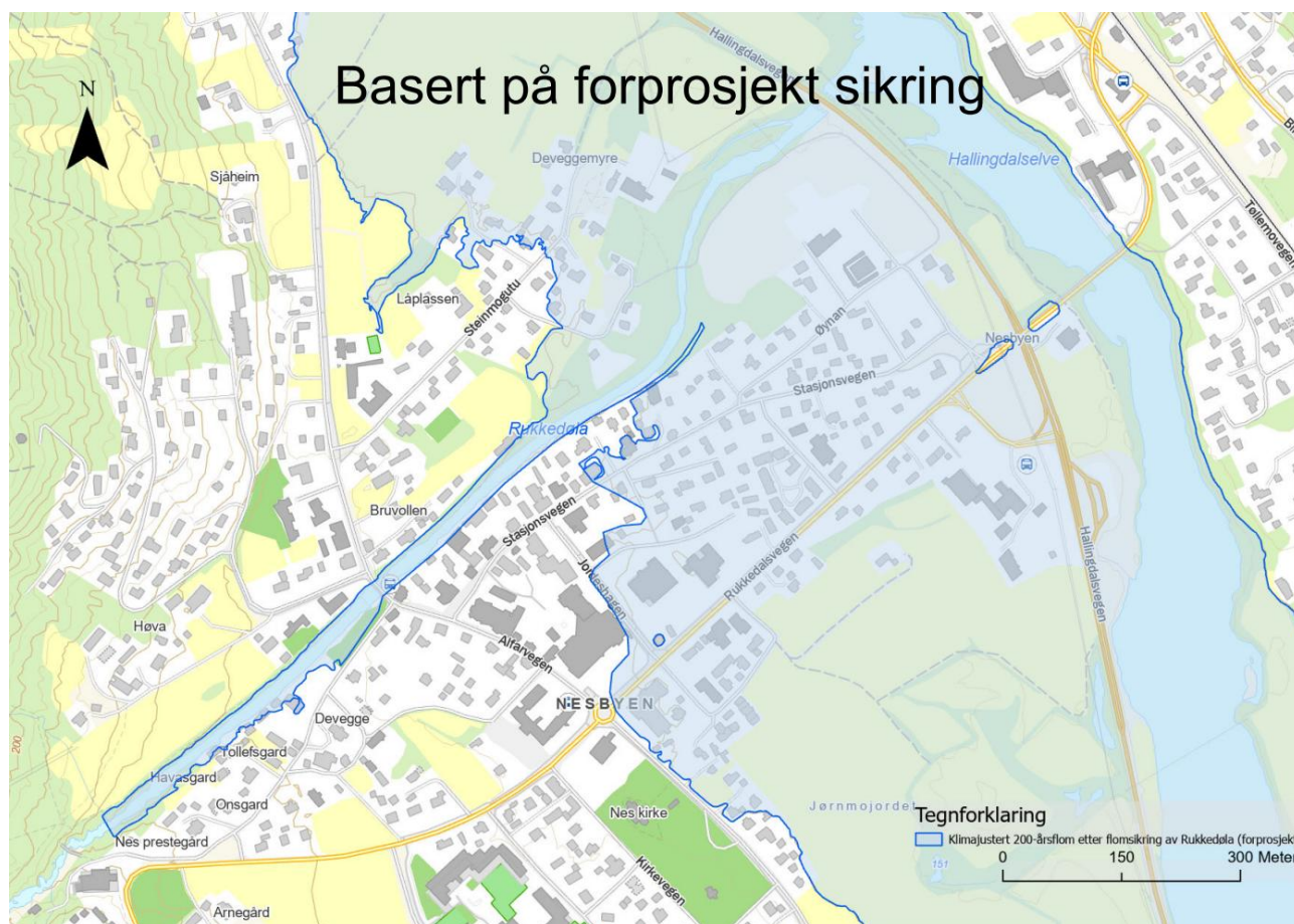
Figur 48. Flomsone for 200-årsflom inkludert klimapåslag dersom Rukkedøla sikres mot flom. I figuren er ikke Hallingdalselva sikret. Kilde: Forprosjekt Rukkedøla.
