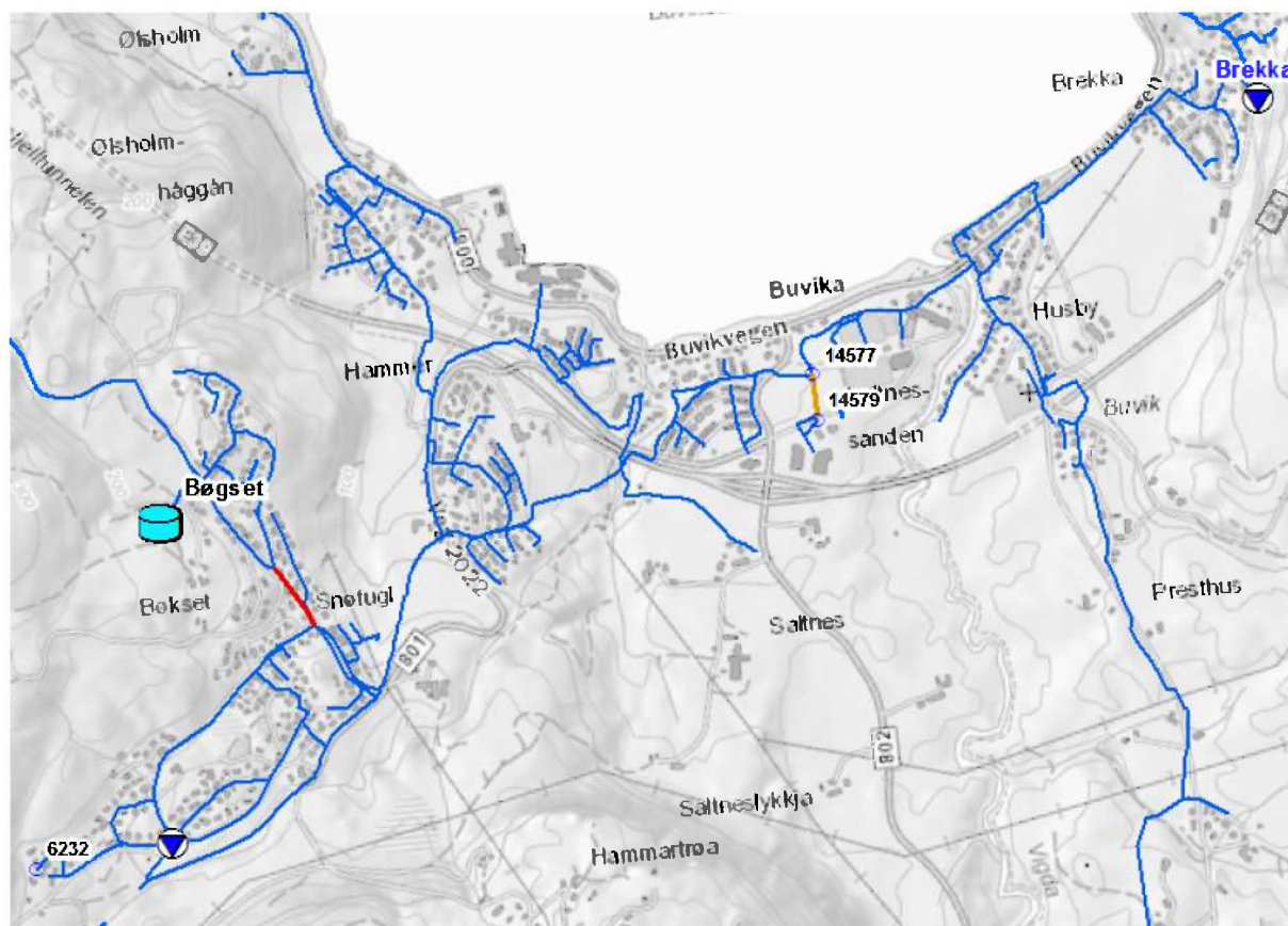
Figur 1-1: Oversiktskart med uttakspunkt (VK 14579 og VK 14577), øverste punkt i Bøgset trykksone (BRA 6232) og Brekka trykkøker. Ø160-ledning i Trøvegen, som begrenser kapasiteten til hele Buvika er markert med rødt, mens Ø110-ledningen inn til den aktuelle tomten er markert med oransje.
