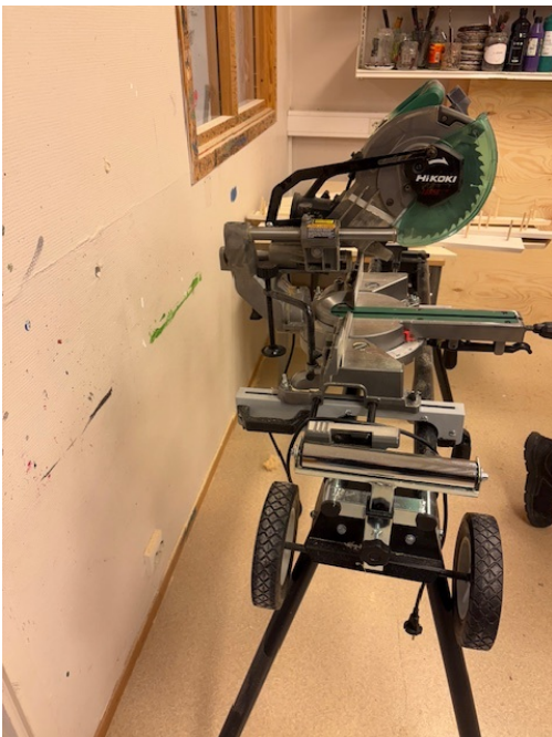
Mangler separat avtrekk
