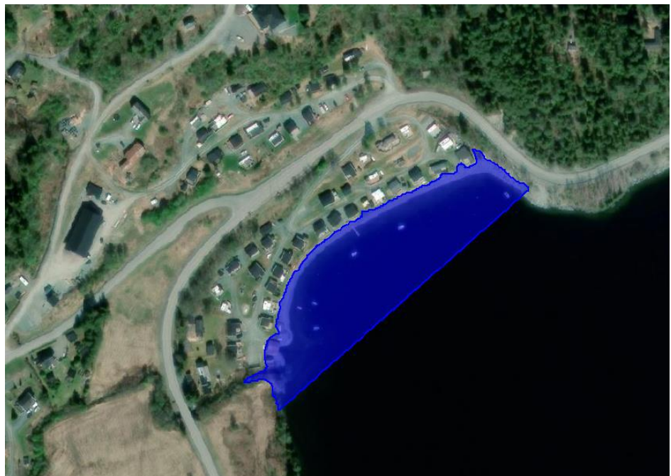
Figur 2: Faresone for flom fra Ånøya vist i blått (Kilde Figur 11 i vedlegg 3).
