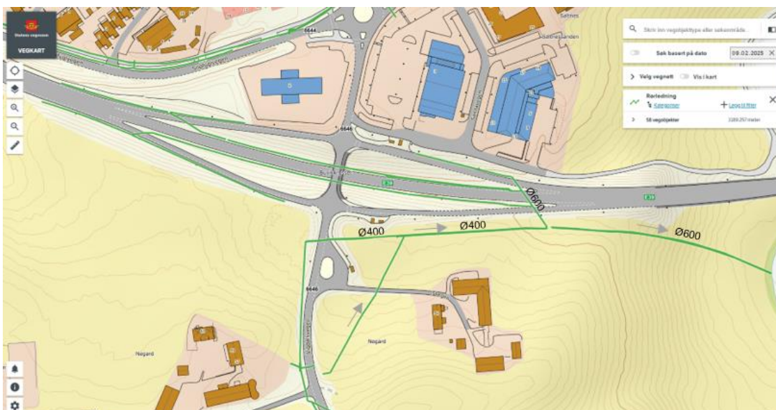
Figur 5-14. Oversikt over eksisterende overvannsledninger tilknyttet planområdet.
