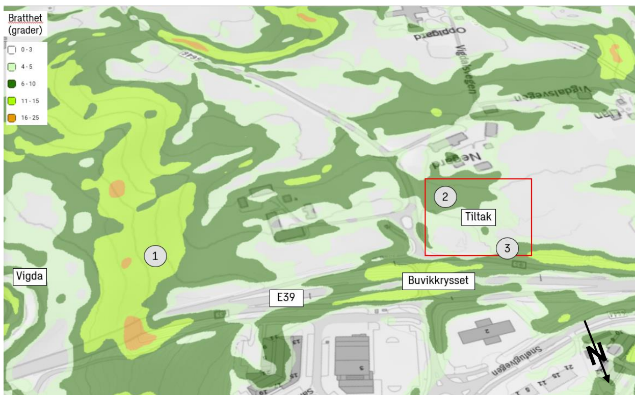
Figur 3 Oversikt over skråninger rundt tiltaket
