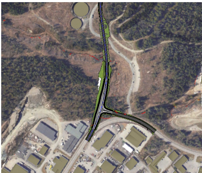
Figur 12: Kanalisert kryss med hovedtrafikken mot Hulkavegen/Klyve
