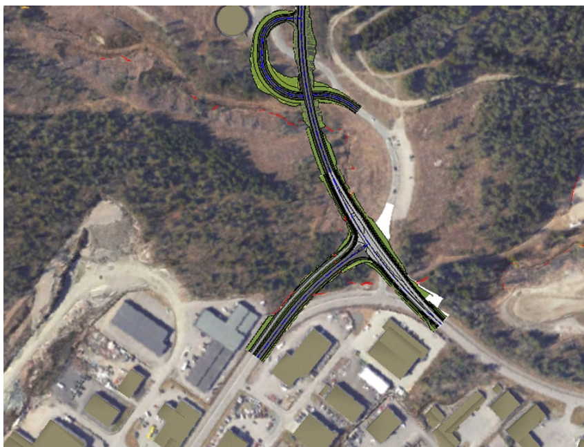
Figur 11: Kanalisert kryss med hovedtrafikken mot Skogplassene/Rødmyrvegen
