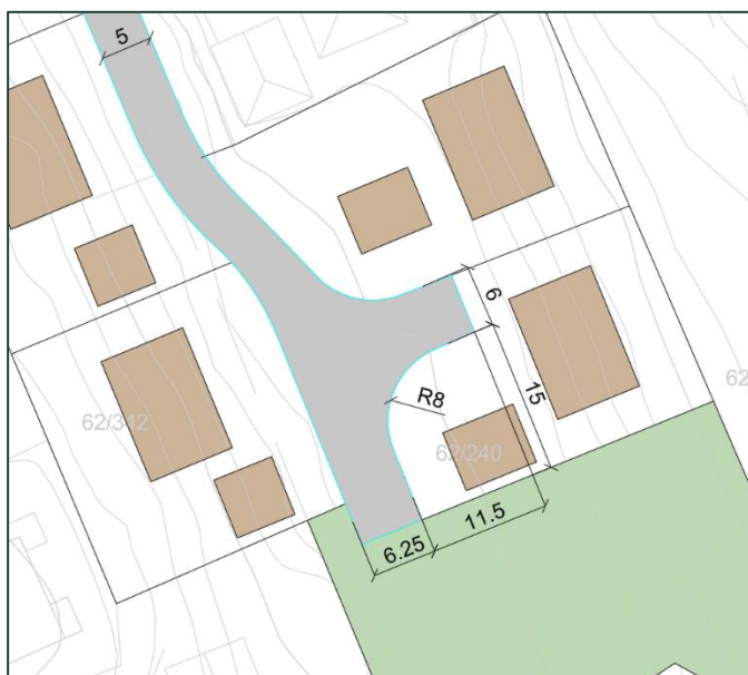
Figur 5-10: Skisse som viser dimensjonering av vendehammer
