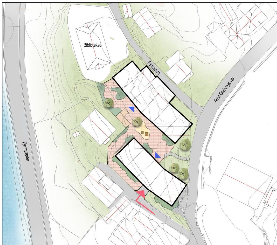
Figur 6: Situasjonsplan for alternativ 2, kjedebebyggelse i rekke, med en mulig utforming av uterommene.
