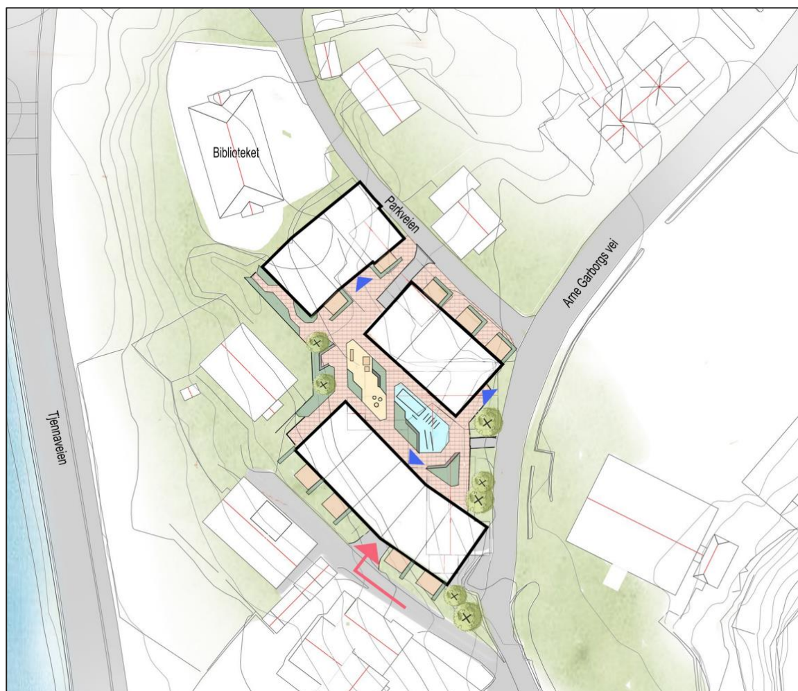
Figur 8: Situasjonsplan for alternativ 2, kjedebebyggelse i rekke med vridd volum og en mulig utforming av uterommene.
