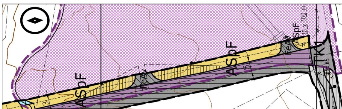
Figur 19. Avkøyrslene frå offentleg veg vert knytt til FeAV i Kråmvikvegen. Reguleringsplan for G/S veg – Raulandsgrend.
