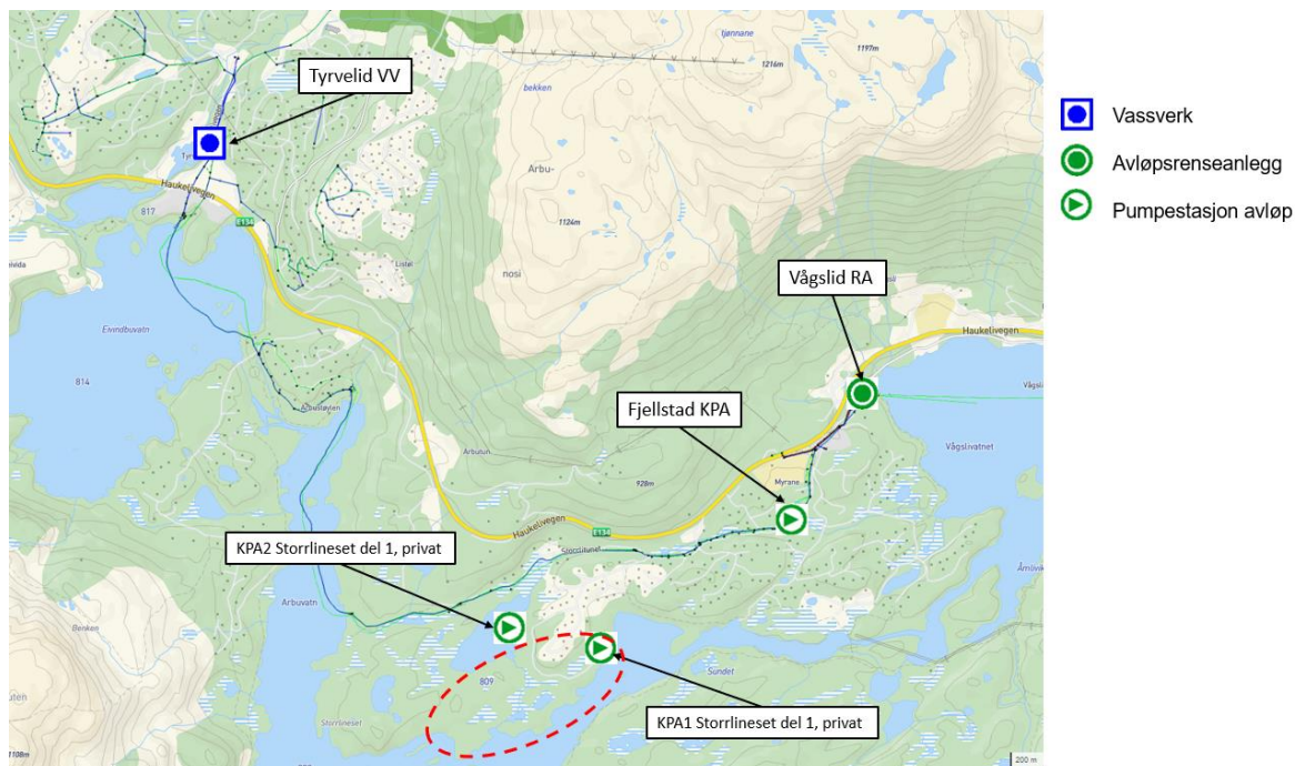
Figur 4 Oversiktskart hovudinfrastruktur for vatn og avløp på Vågslid samt private pumpestasjonar på Storlineset. Planområdet er markert med raudt.
