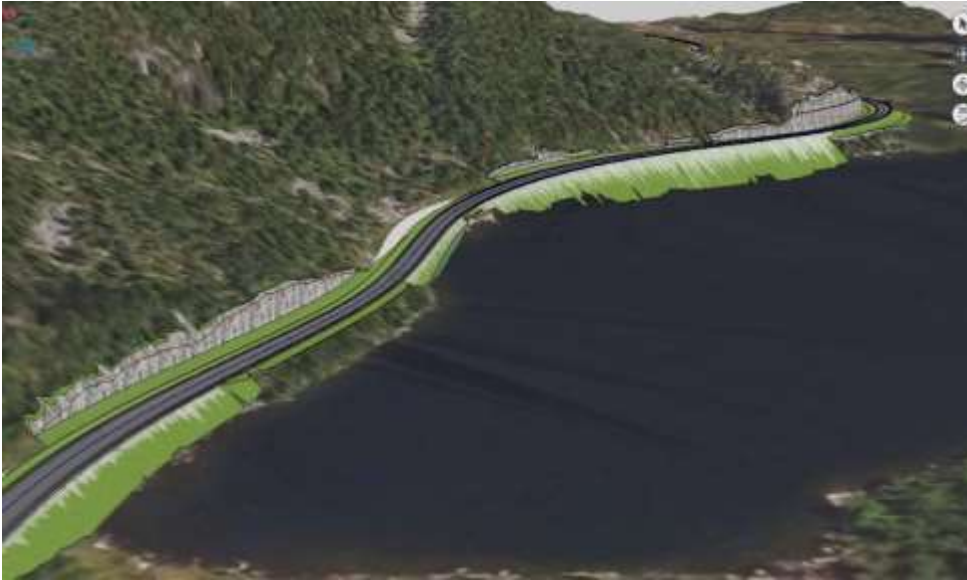
Figur 2. Nord for Kvervesjø, mellom Langeidvatn og Urdlinuten utbedres veien med nye skjæringer og fyllinger. Massene fra veiskjæringer benyttes til etablering av slakere terreng på samme veistrekning.
