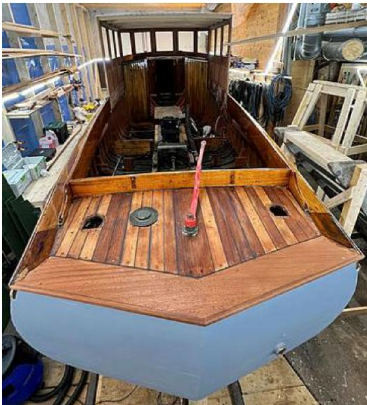
Bilde 46 Lakkering av skandbord og akterdekk
