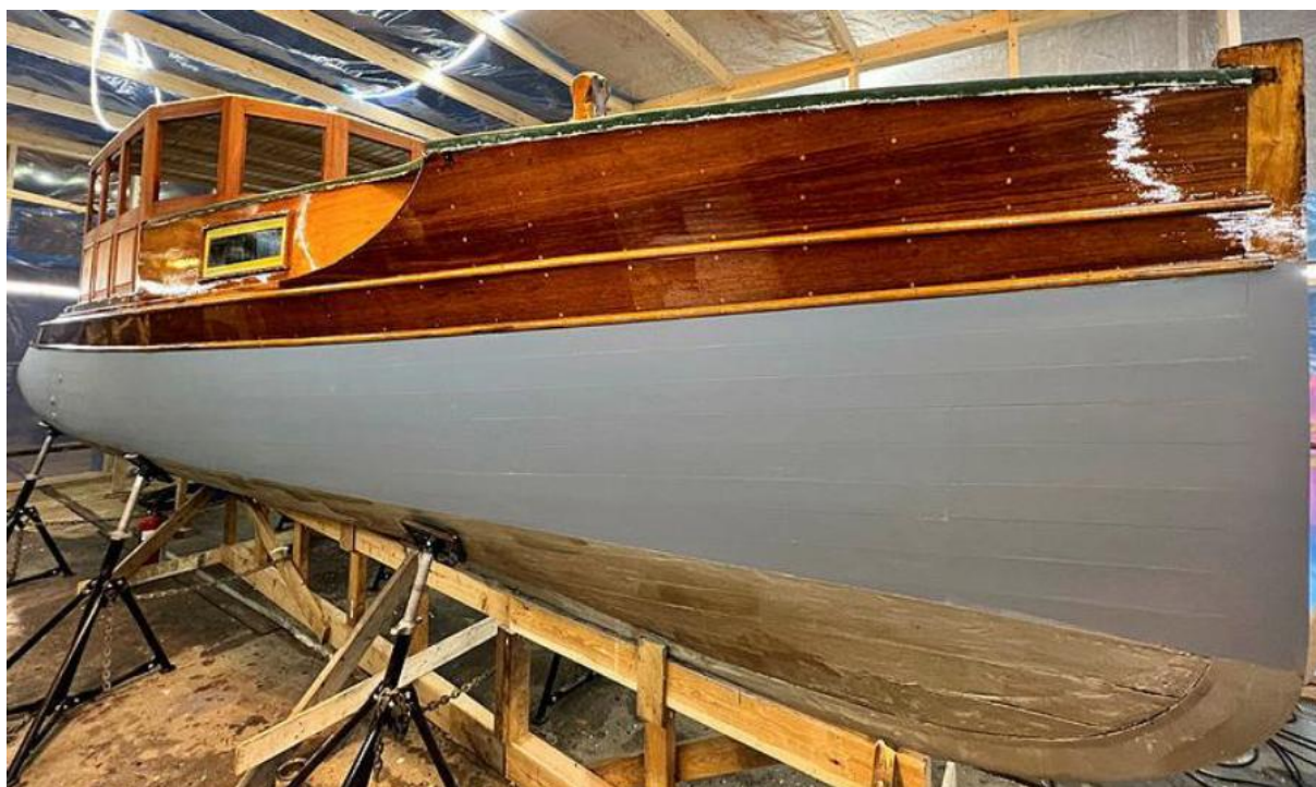
Bilde 43 Sett fra styrbord side. Vindu som er i salongen, er ført tilbake til tidsriktig utførelse med rett fasong som tidligere.
