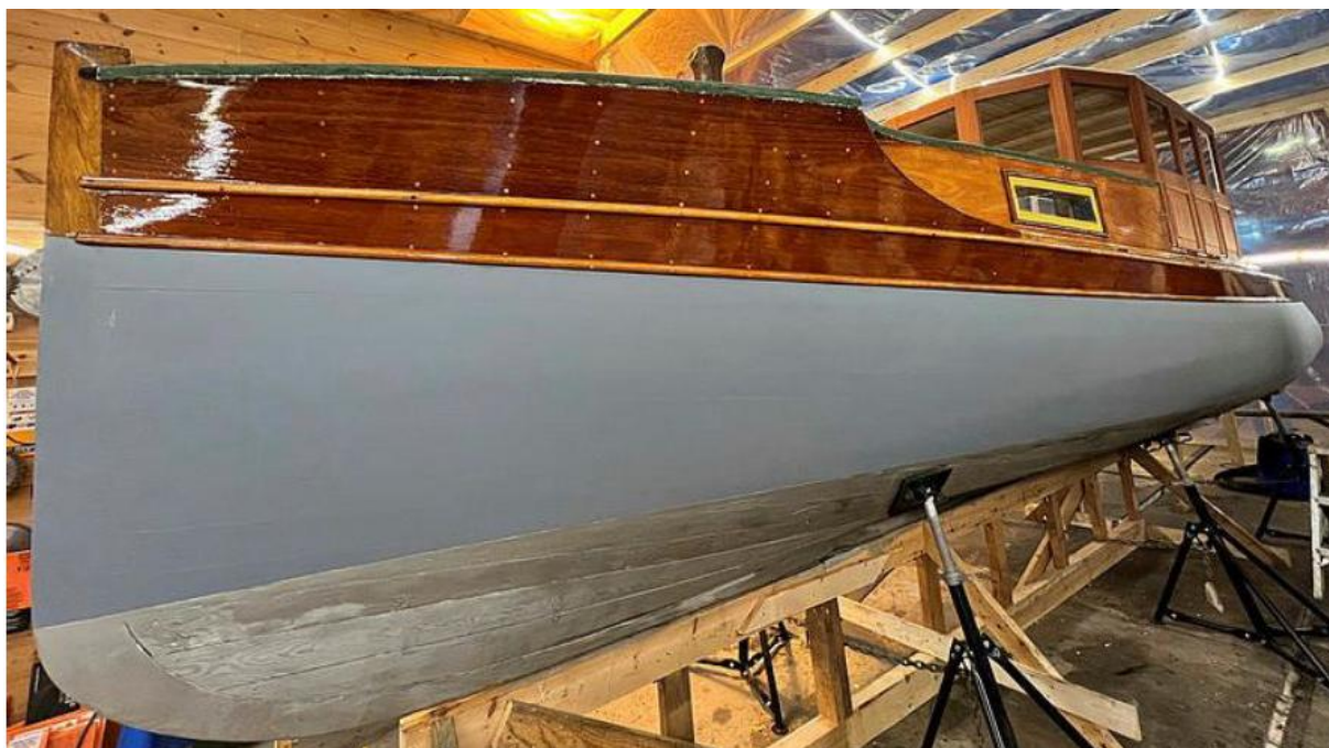
Bilde 42 Vannlinje laget med et spor risset inn i huden. Huden under vannlinje er impregnert, primet, og grunnet. Fribord lakker første strøk.
