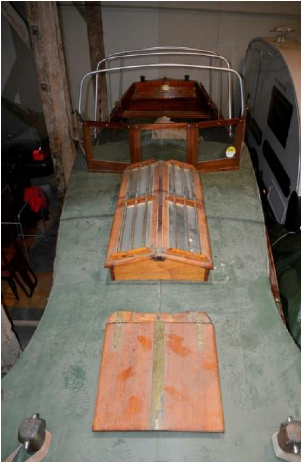
Bilde 31 Skylight og luke på fordekk
