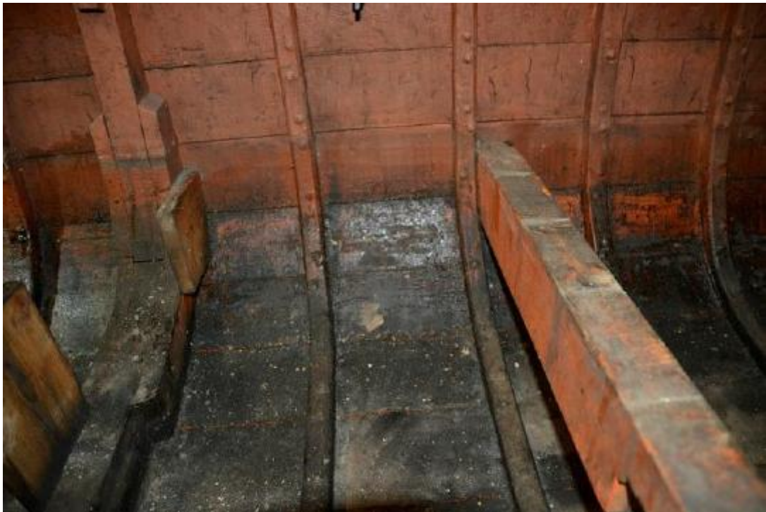
Bilde 22 Ribber, bunnstokk og skjøtestykke babord side
