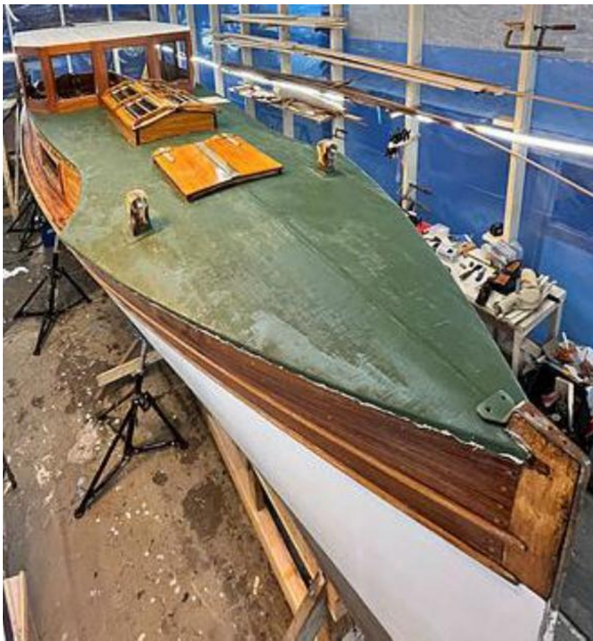
Bilde 48 Seilduken etterstramet og slipt ned for siste st k maling. Luke, og skylight remoter tilbake for optimal tetting til seilduk.
